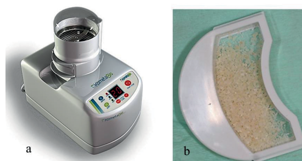
Ryc. 2 Młynek „Smart Dentin Grinder” i jego zbiornik wypełniony gotowym do sterylizacji proszkiem zębinowym o średnicy cząsteczek 300-1200 µm. (a) Smart Dentin Grinder, (b) Szufladka młynka, w której gromadzone są fragmenty zębiny po zmieleniu i przesianiu przez zintegrowane z urządzeniem sito. Jedynie cząsteczki o średnicy 300-1200 µm lądują w zbiorniku.
